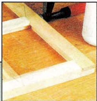
Шиповое соединение относится к числу самых прочных.
