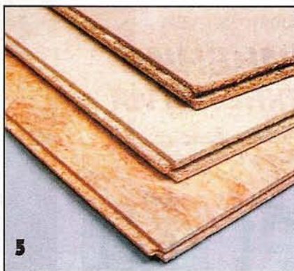
5 Соединяемые в паз и гребень обычные ДСП из хвойных пород, а также ДСП с ориентированной стружкой используют для чёрного пола, а последние (внизу) — даже для устройства чистового напольного покрытия.
