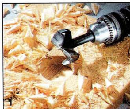
При сверлении сверлом Форстнера стенки отверстия получаются гладкими. У глухих отверстий гладким будет и их дно.
