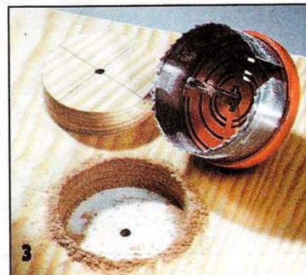
Кольцевые пилы вырезают отверстия с чистыми стенками. Направляющее сверло определяет положение кольцевой пилы.
