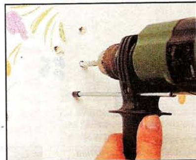
Упор, прикреплённый к рукоятке электродрели, позволяет просверлить отверстие заданной глубины, что предотвратит случайное сверление насквозь, в частности, — тонких лёгких перегородок.
