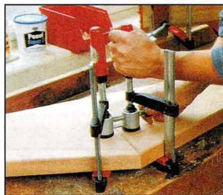
Каркасы стульев склеивать особенно сложно. Ленточные зажимы справляются с этой задачей и стягивают всю конструкцию в единое целое.
