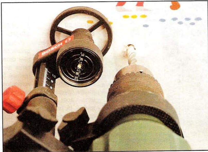
Приспособление для сверления отверстий позволяет просверлить их строго перпендикулярно стене.
