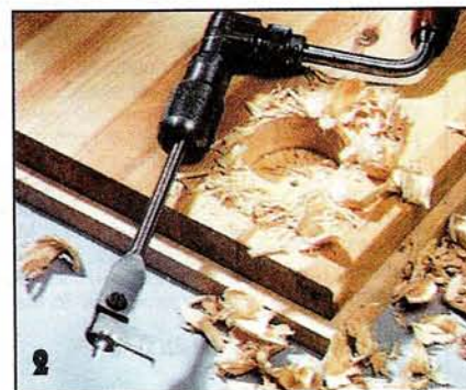
У регулируемого перового сверла резец можно переставлять и фиксировать в требуемом положении. Приводом для таких свёрл может служить достаточно мощная электродрель или коловорот.
